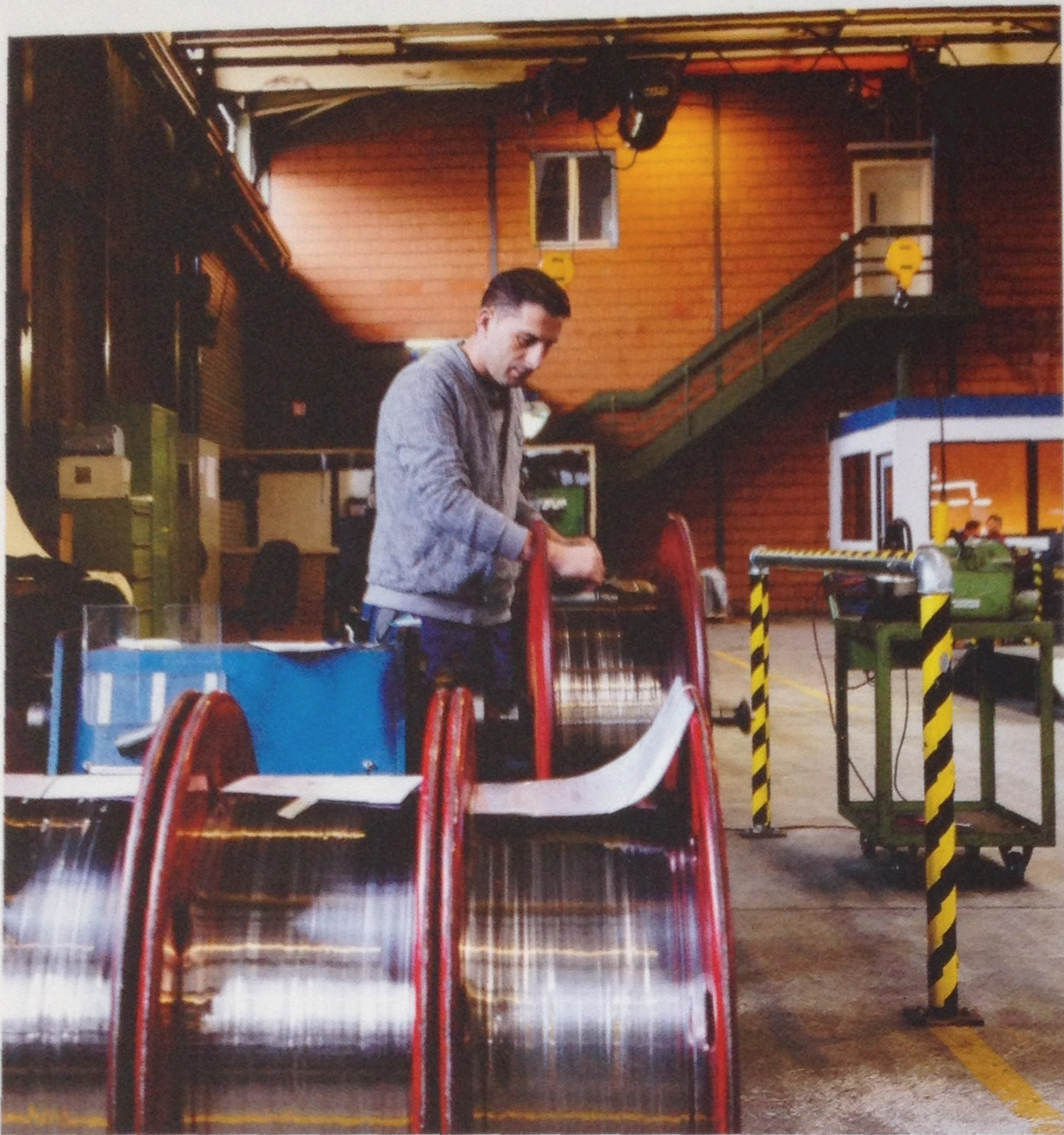
Après le laminage, le fil plat est enroulé sur des bobines. De cette façon, il peut être ensuite usiné le plus efficacement possible.
