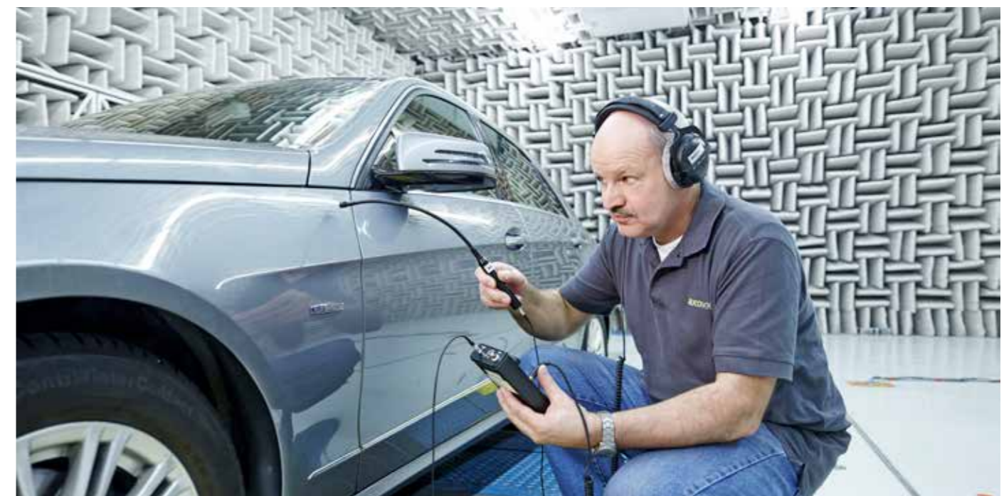
Geräuschmessung im reflexionsfreien Testraum
