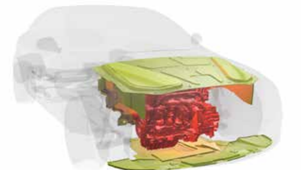
Motorkapselungen aus speziellem Isoliermaterial
