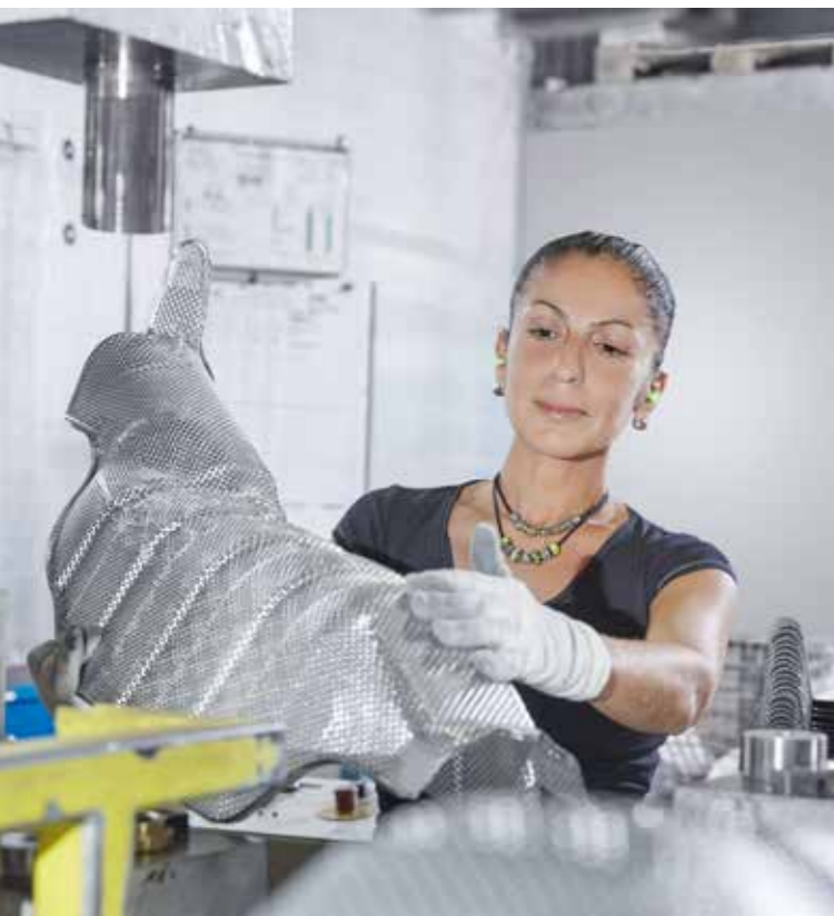
Produktion eines Hitzeschildes für den Fahrzeugunterboden bei Autoneum
