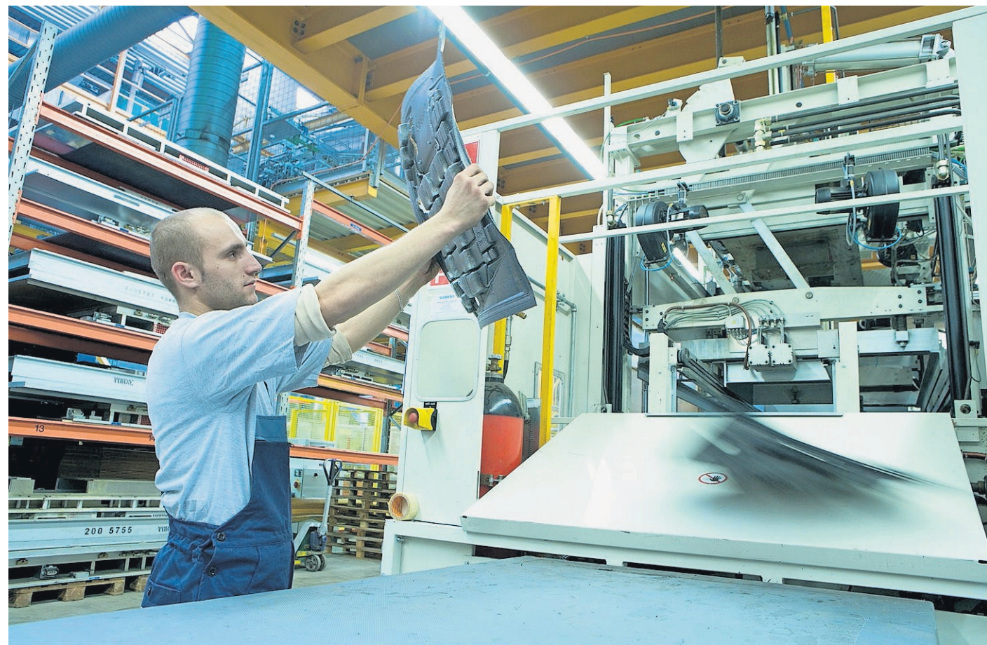
Herstellung von Unterbodenverkleidungen im Autoneum-Werk in Sevelen.
