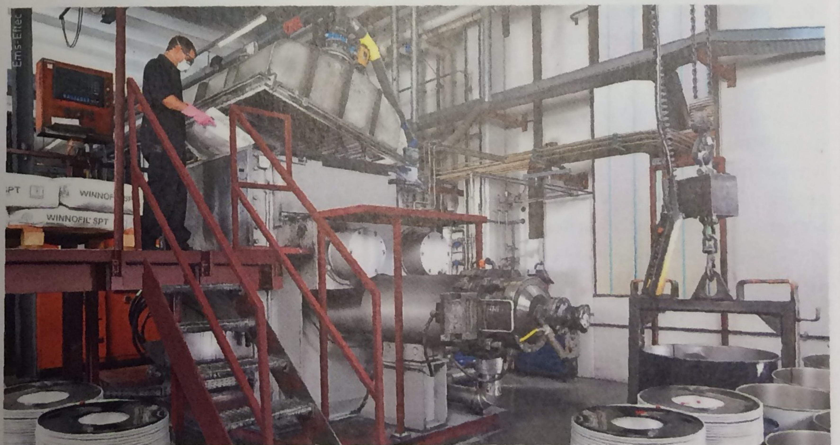
Produktion von Karosseriebau-Klebstoffen bei EMS-Eftec in Romanshorn. Die EMS-Gruppe generiert rund 50% ihres Umsatzes im Automobilmarkt.
